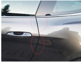
Interstices de toutes les portières du véhicule (impérativement information textuelle indiquant si interstice modifié)
