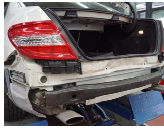
Cliché détaillé de la détérioration sans carénage
